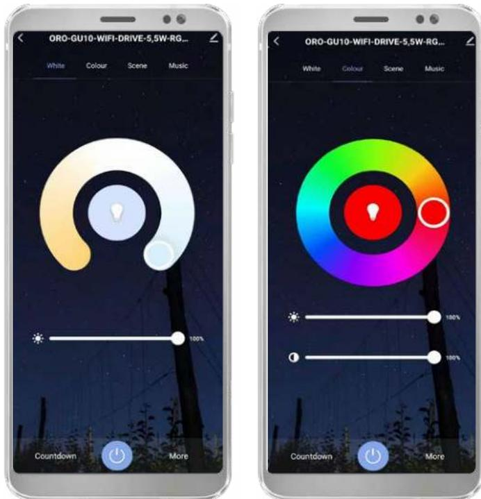
Geräte, die mit einem bestimmten LED-Typ ausgestattet sind, haben folgende Funktionen zur Wahl: Änderung der Lichttemperatur, Dimmfunktion, Ein-/Auszuschalten, Farbwechsel, Einstellung der Farbsättigung, Minuten-Timer und Erstellung von Lichtzeitplänen. Diese Funktionen sind in mehrere Grundfelder unterteilt.
