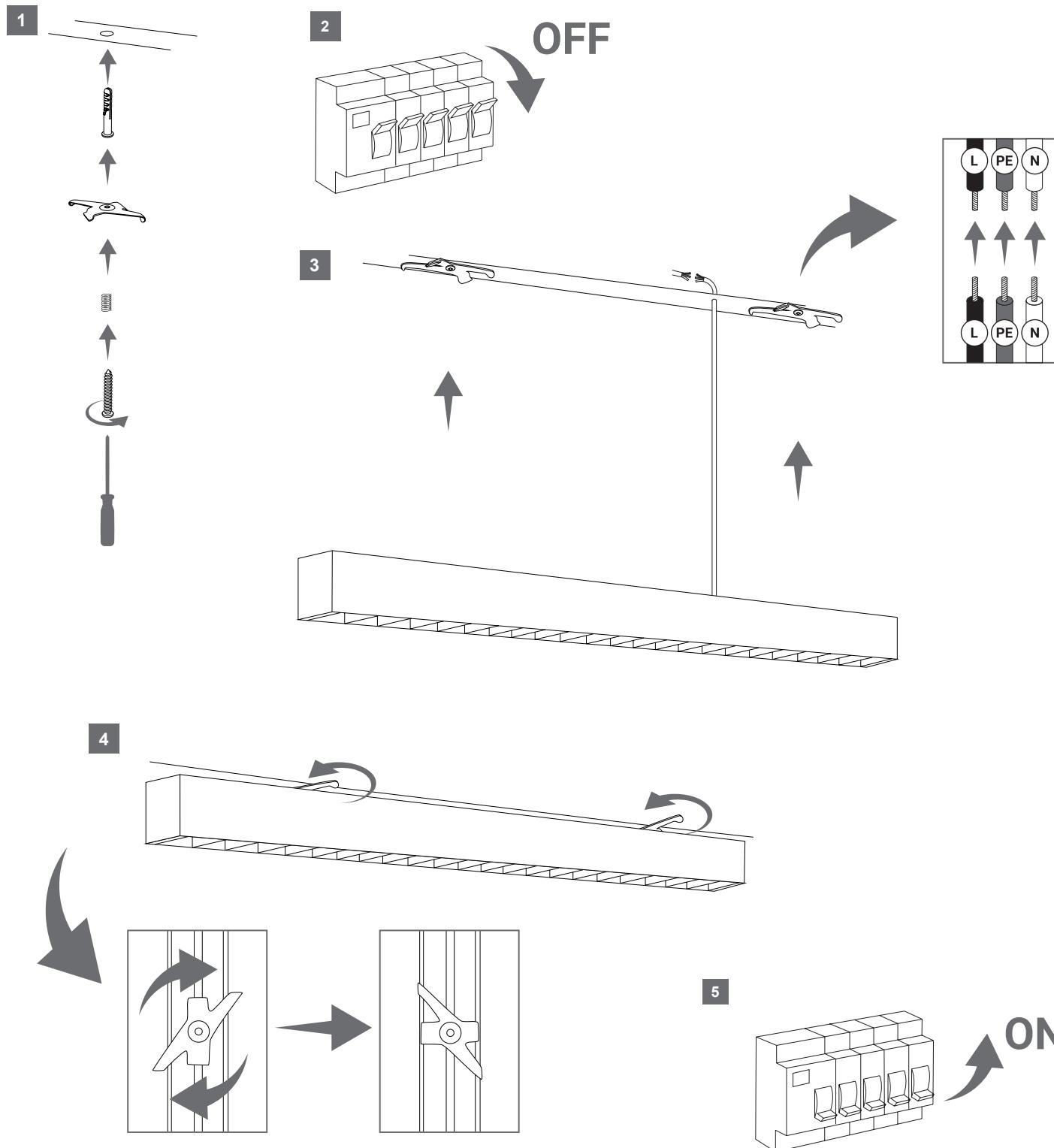
**PL MONTAŻ PODWIESZANY / EN INSTALLATION OF SUSPENDED / DE UNTERDECKENMONTAGE / CZ MONTÁŽ ZAVĚŠENÝCH / SK MONTÁŽ PODHLÁDOVÝCH / HU FELFÜG-GESZTÉSE / GR ΤΟΠΟΘΕΤΗΣΗ ΚΡΕΜΑΣΤΩΝ / PT MONTAGEM NO TETO FALSO / HR MONTAŽA VISEČIH / RU ПОДВЕСНАЯ УСТАНОВКА / RO MONTAREA SUSPENDATE / UA ВСТАНОВЛЕННЯ ПІДВІСНИХ / LT KABINIMO MONTAVIMAS / LV GAISMA UZSTĀDIŠANA / EE RIPPLAE PAIGALDAMINE / DK INSTALLATION AF NEDHÆNGTE / SE INSTALLATION AV HÄNGANDE / NO INSTALLASJON AV HENGENDE**
